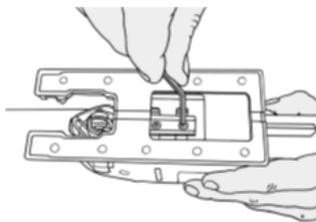
1. С помощью шестигранного ключа ослабьте фиксирующие подошву винты, расположенные с нижней стороны корпуса лобзика.
