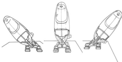
Чтобы получить наклонный спил, отрегулируйте угол наклона лобзика относительно подошвы (см. раздел «Сборка»).
