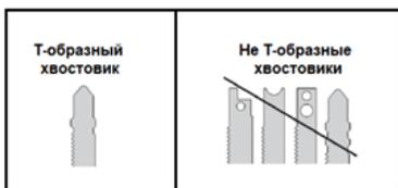
Используйте только ровные, чистые и острые пилки. Запрещается использовать изогнутые, треснутые пилки или пилки с поврежденными зубцами.
