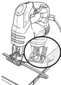
Направляющая линейка используется для пиления параллельно базовой кромке заготовки. Установите направляющую линейку и отмерьте ей нужное расстояние (см. раздел «Сборка»).
