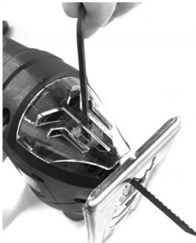
1. С помощью шестигранного ключа (8) ослабьте два винта фиксации пилки, поворачивая их против часовой стрелки. Нет необходимости полностью выкручивать винты, в противном случае вам будет сложно закрутить их шестигранным ключом обратно из-за нехватки пространства между защитным экраном и механизмом.
