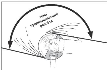
Поверните защитный кожух в такое положение, которое обеспечит максимальную защиту оператора от искр и частиц материала, вылетающих во время работы. Закрутите винт фиксации кожуха (3) отверткой.
