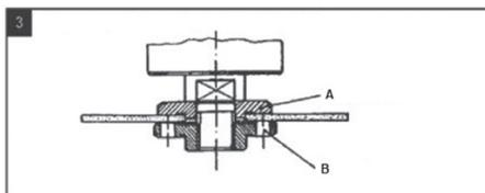
(А - прижимный фланец, В – зажимная гайка)
