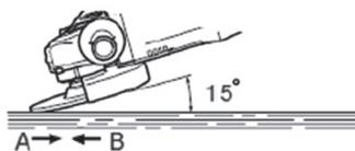
Во время шлифовальных работ удерживайте шлифовальный диск под углом примерно 15 градусов к обрабатываемой поверхности, это обеспечит наилучший результат и предотвратит приложение чрезмерного усилия к машине.
