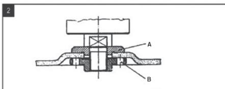
(А - прижимный фланец, В – зажимная гайка)
