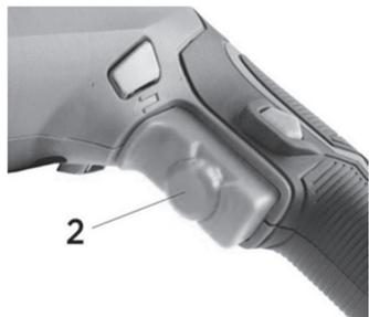
На кнопке «Пуск» располагается колесико ограничителя скорости вращения (2). Вращение этого ограничителя определяет максимальную глубину нажатия кнопки «Пуск» и таким образом максимальную скорость вращения инструмента. Поворачивайте регулятор в сторону знака «+», чтобы увеличивать максимальную скорость вращения, или в сторону знака «-», чтобы уменьшать.
